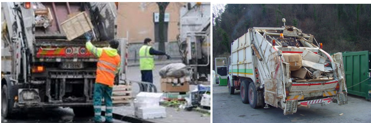
Figure 11, 12 – Rischio da caduta di oggetti: questa situazione si verifica generalmente durante il riempimento del compattatore nella raccolta dei rifiuti dai cassonetti, legata a un eccessivo riempimento o a malfunzionamenti del meccanismo di salita e discesa del gruppo presa, dovuta a scarsa manutenzione, o scuotimento del cassonetto nel compattatore per favorire lo scarico di materiale ingombrante, operazione vietata dalla maggior parte delle aziende.
