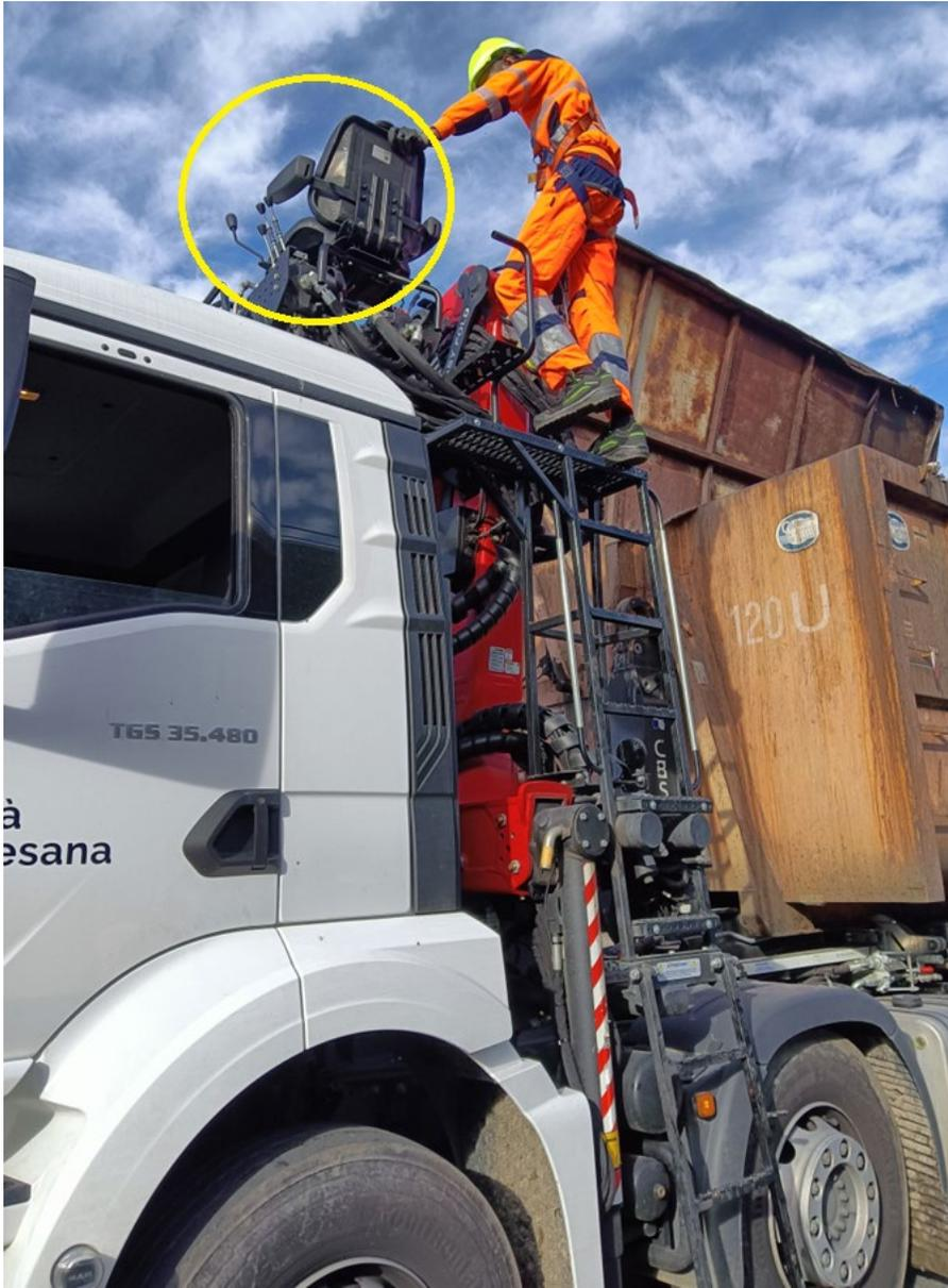
L'altezza del sedile da terra è compresa tra i 2,20 m e i 2,60m e solo quando l'operatore si siede sul sedile stesso per iniziare le manovre può inserire la cintura di sicurezza.
